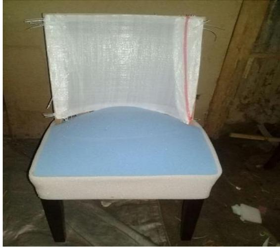
*Figura 39.* Proceso del tapizado, Colocando las espumas en el Asiento y en el espaldar costal de saco
