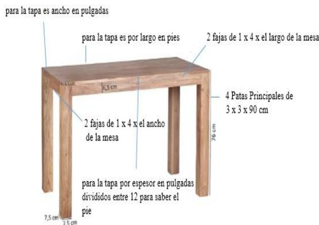
Figura 20. Partes de una mesa en madera tornillo
