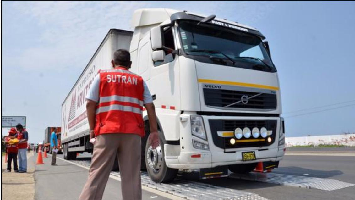
Estas básculas para camiones pueden ser totalmente de acero sobre plataforma o preparadas con hormigón y pueden colocarse en el suelo o en foso bajo según las necesidades del lugar de instalación.
