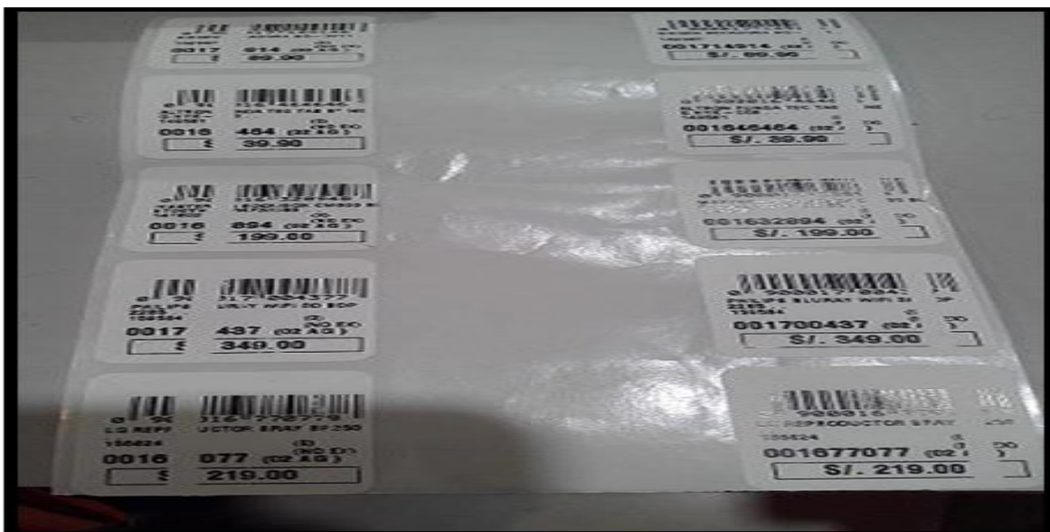
Figura 4. Etiquetas de barras con fallas de impresión
